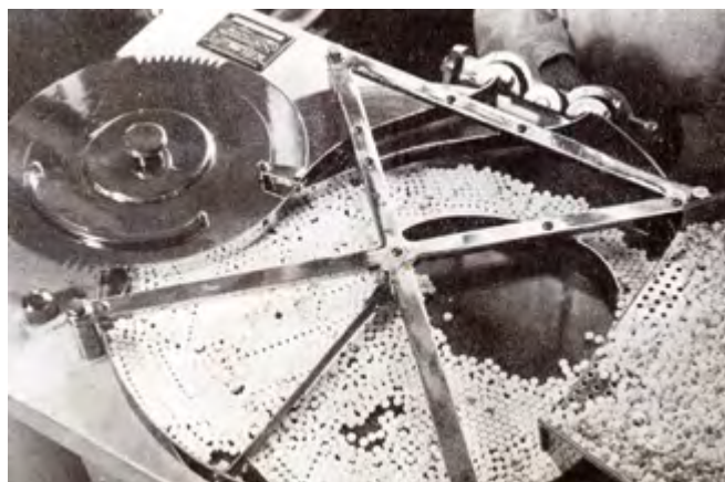
Strojno štetje tablet in dražejev sredi prejšnjega stoletja. Vir: Lek farmacevtska družba d.d.
